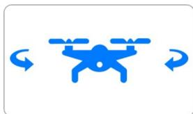
1. 左摇杆左右方向为偏航杆，用于操控飞行器的航向。
